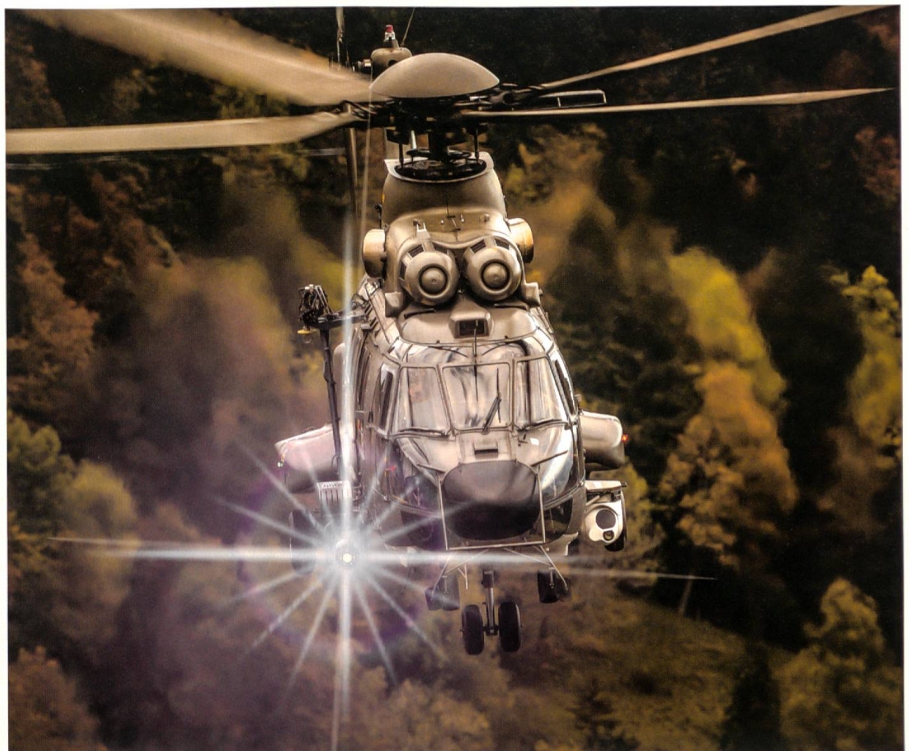
Mit Suchscheinwerfer (links) und Infrarotkamera (rechts) ausgestatteter Super Puma.
