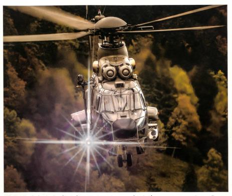
Mit Suchscheinwerfer (links) und Infrarotkamera (rechts) ausgestatteter Super Puma.
