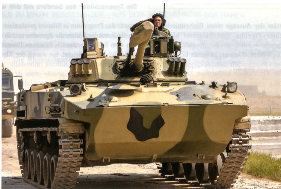
Der Luftlandepanzer BMD-4M. Die Bewaffnung «Bachtscha-U» besteht aus der 100-mm-Kanone 2A70, die mit der 30-mm-Maschinenkanone 2A42 und einem 7,62-mm-MG PKT gekoppelt ist. Aus der Kanone 2A70 werden Lenkraketen 9K116-3 Basnya gestartet. Die Crew besteht aus zwei Besatzern und fünf Luftlandesoldaten. Sie sind mit persönlichen Waffen ausgestattet. Abwurf erfolgt am Fallschirmsystem PBS-950.
