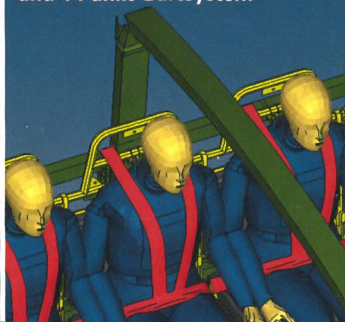
Neuer Aufbau mit Überrollschutz und 4-Punkt Gurtsystem
