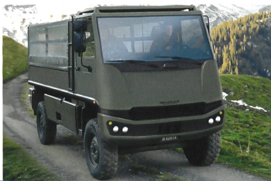
Neuer Aufbau mit Überrollschutz und 4-Punkt Gurtsystem
