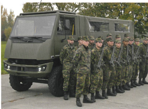
Neuer Aufbau mit Überrollschutz und 4-Punkt Gurtsystem
