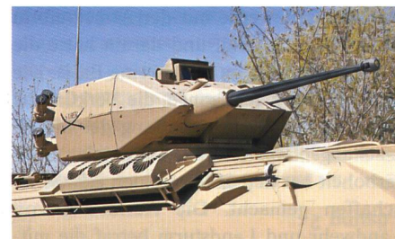
Türkischer Turm SABER 25 für gepanzerte Rad- oder Kettenfahrzeuge.
