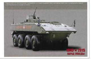
Strasse eine Höchstgeschwindigkeit von 90 bis 100 km/h und eine mittlere Reichweite von 800 km ohne zu tanken, im Wasser erreicht das Fahrzeug durch die Antriebsschraube am Heck eine Geschwindigkeit von 5 bis 10 km/h.
