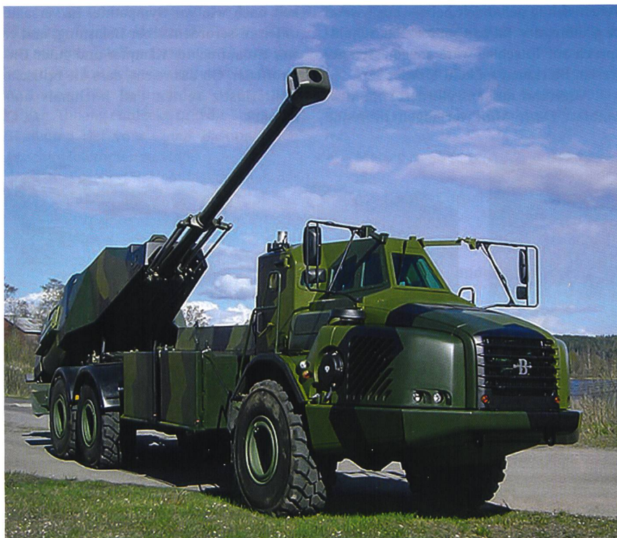
Das ARCHER-Geschütz mit dem 155-mm-Rohr auf dem gut geschützten Fahrzeug.
