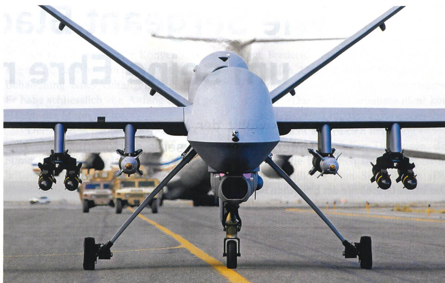
Die Reaper-Drohne MQ9A kann mit zwei lasergesteuerten GBU-12-500-Pfund-Bomben und vier AGM-114A-Hellfire-Raketen bewaffnet werden. Die Höchstgeschwindigkeit beträgt 470 km/h, die Flughöhe 1520 Meter. Die Royal Air Force setzt im Nahen Osten zehn Reaper ein.
