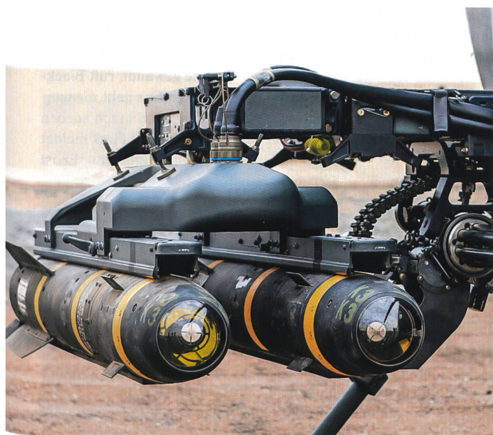
Die gefürchtete AGM-114A-Hellfire-Rakete: Maximaldistanz 7,5 Kilometer. Steuerung semi-active laser homing (SALM). Gefechtskopf 8 kg. Länge 163 cm. Gewicht 45 kg.
