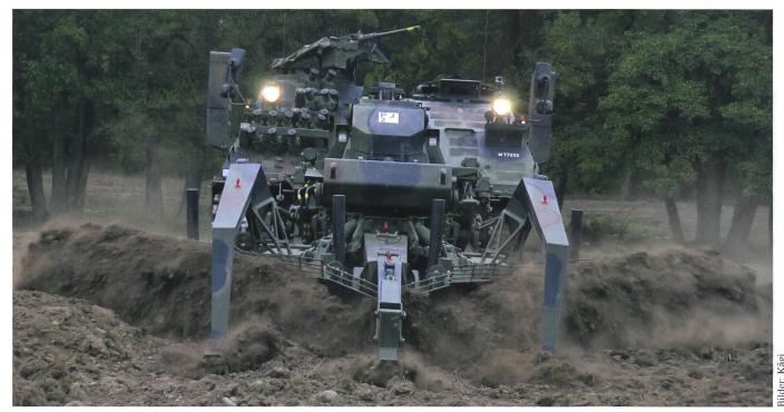
Der neue, schwere Genie- und Minenräumpanzer Kodiak pflügt eine Minengasse.
