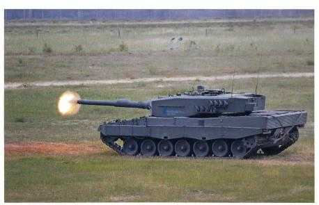
Ein Leopard 2 verschiesst mit seiner Glattrohr-Kanone ein Wuchtgeschoss DM63A 1.
