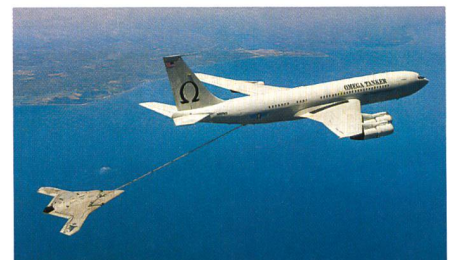
Erste vollautonome Luftbetankung eines unbemannten Luftfahrzeuges.
