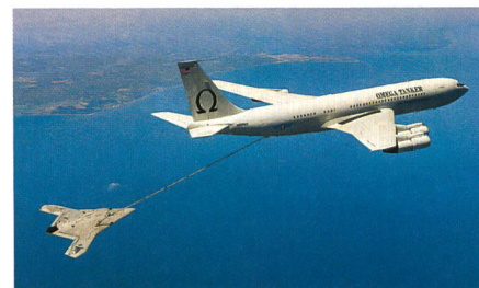
Erste vollautonome Luftbetankung eines unbemannten Luftfahrzeuges.
