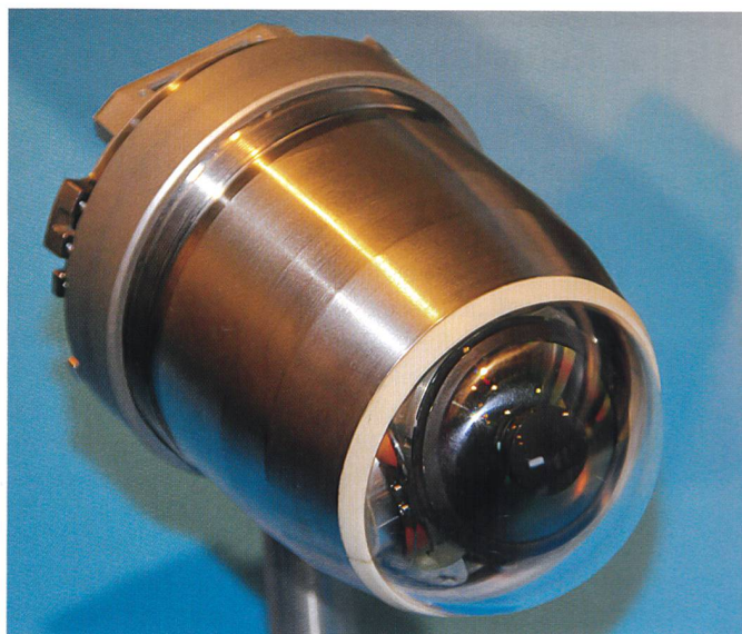
Ausgebauter Suchkopf. IRIS-T SL besitzt eine aussergewöhnlich hohe Auflösung, Zieldiskriminierung und Störfestigkeit.
