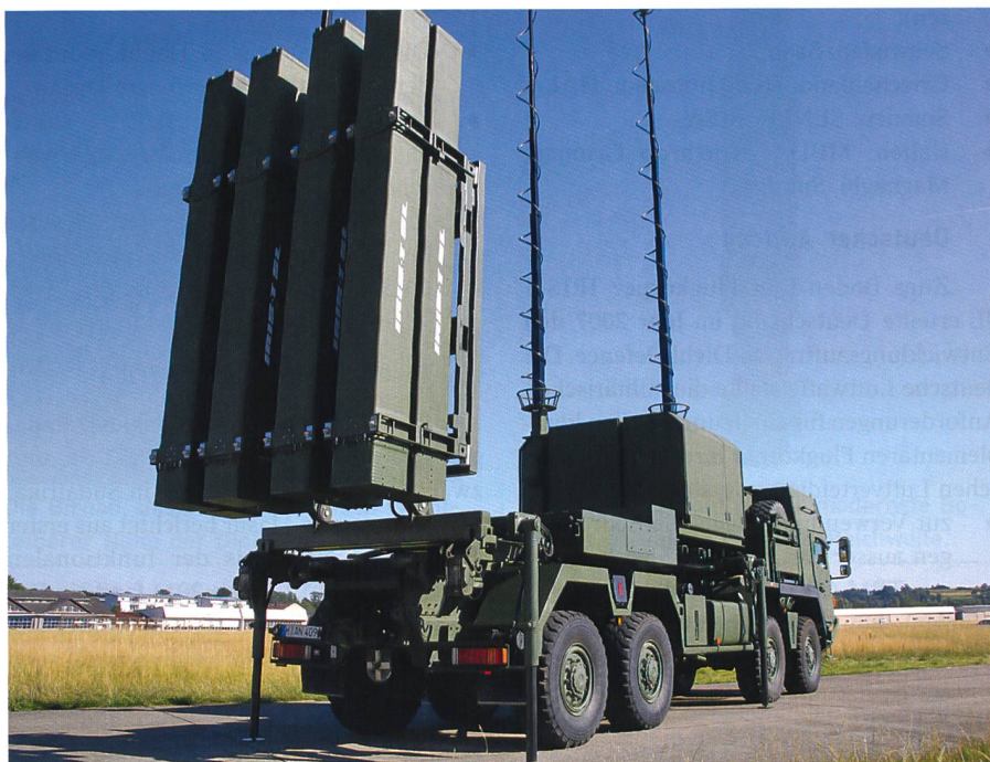
Die Fiberglas-Behälter für acht IRIS-T SL auf dem stark gepanzerten Trägerfahrzeug.
