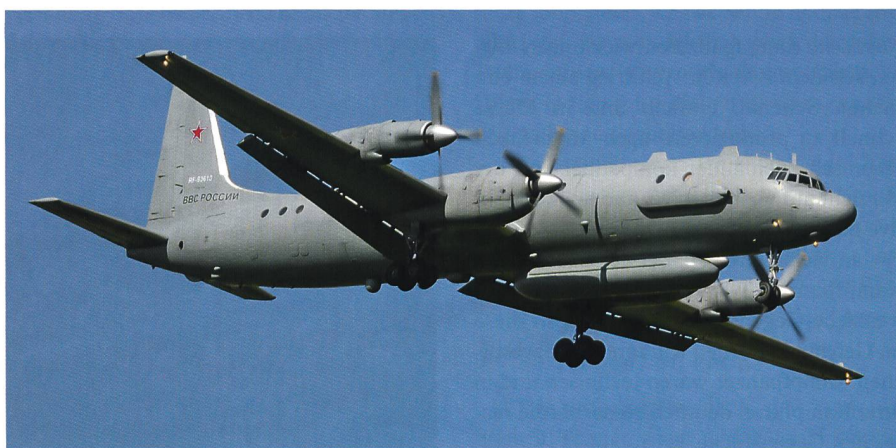
Der russische Aufklärer Il-20. Gut erkennbar unter dem Rumpf das Radargehäuse.
