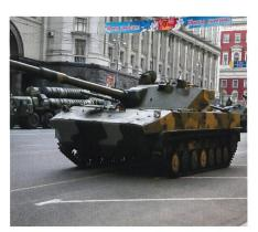
Der russische Luftlandepanzer Sprut mit der 125-mm-Glattrohrkanone.
