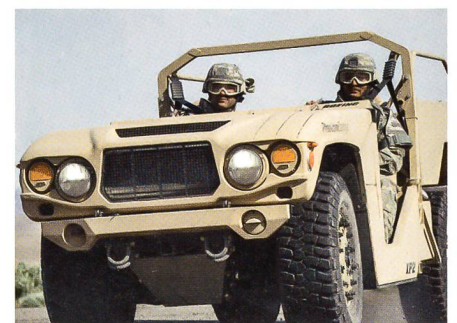
Geländefahrzeug Phantom Badger – für den Transport mit der V-22 entworfen.
