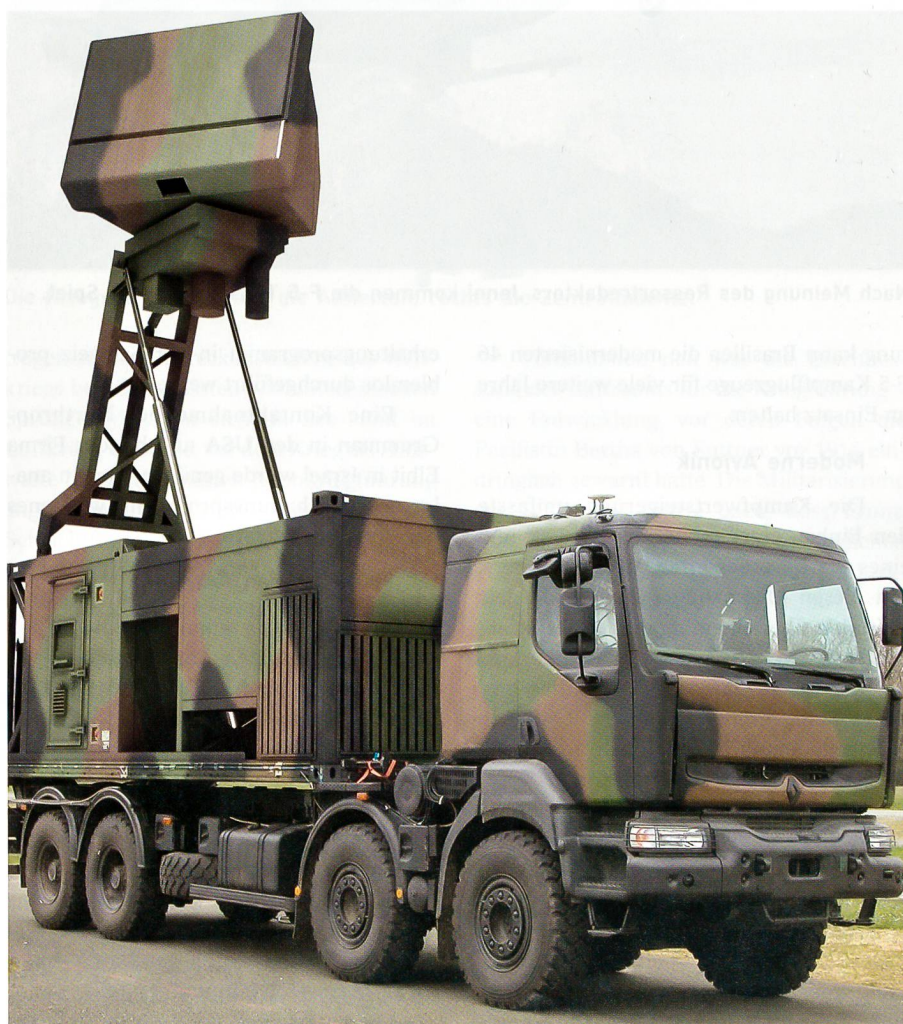
Das Multifunktionsradar CM200 dient der Luftraumüberwachung auf mittlere Distanzen bis 250 Kilometer und als Feuerleitradar.
