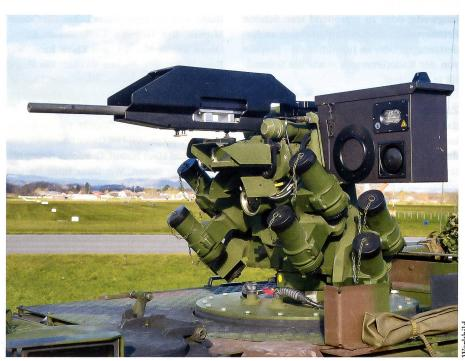
Um eine realistische Ausbildung mit den geschützten Mannschaftstransportfahrzeugen zu ermöglichen, wird die aufgebaute Waffenstation mit Lasersendern (Aktivsystem) und einem Passivsystem (Ziel erkennt die Treffer) versehen.
