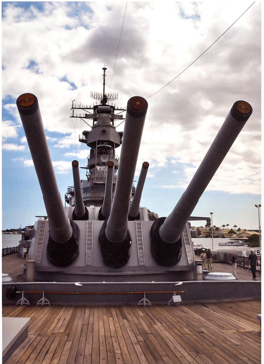
Blick vom Vorschiff der USS Missouri auf die vorderen Geschütztürme mit je drei 40,6-cm-Geschützen, die je rund 900 kg schwere Granaten über 42 km feuern konnten.
