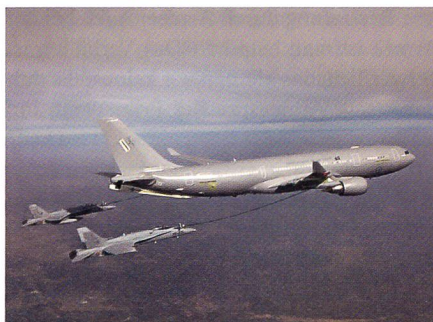
Tankflugzeug des Typs A330 MRTT bei der Abfertigung von zwei F/A-18.
