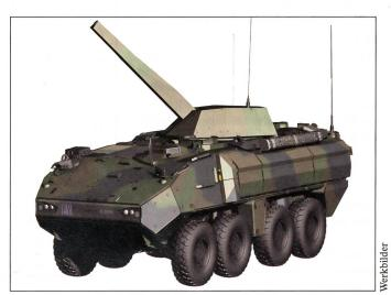
CAD-Bild vom NEMO-120-Millimeter-Minenwerfer auf Piranha-3.
