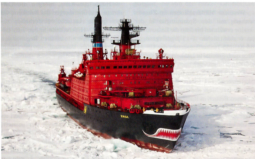
Der russische nuklear betriebene Eisbrecher «Yamal» der «Arktika»-Klasse. Verdrängung 23 400 Tonnen. Kann bis 100 Passagiere und Touristen mitführen.
