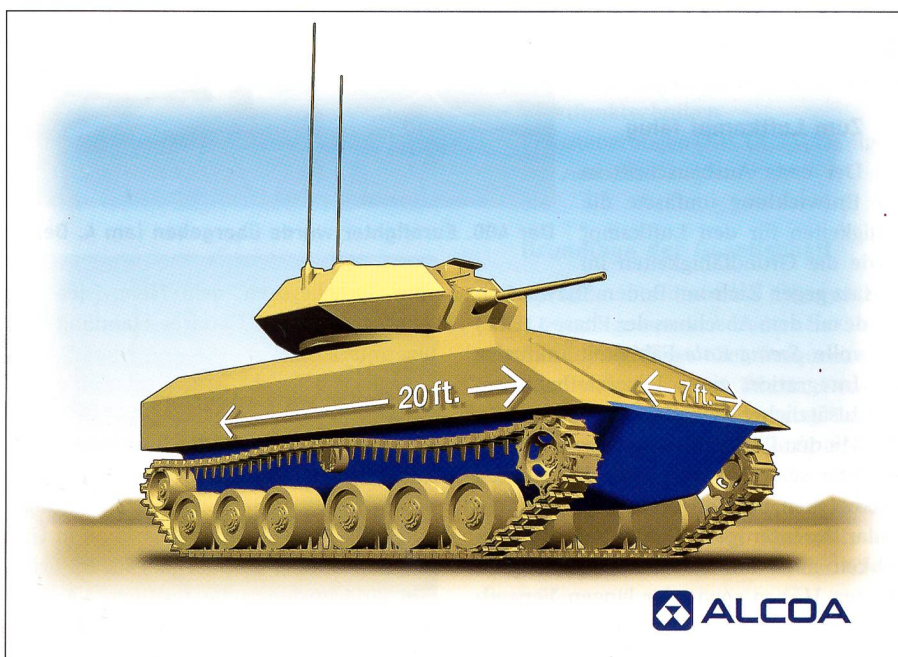
Blau erkennbar die neue Wanne aus Aluminium. 20 Feet = 6,09 m. 7 Feet = 2,13 m.
