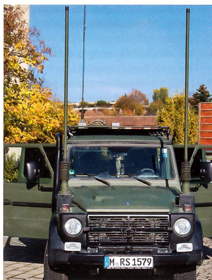
Rohde & Schwarz-Kommunikationsfahrzeug mit breitbandigen Antennen.
