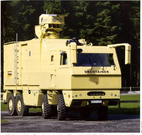
Mit dem auf dem Tatra-Lastwagen installierten 20-kW-HEL-Effektor wurden auf Entfernungen bis 2000 Meter Optroniken und Zielfernrohre neutralisiert.
