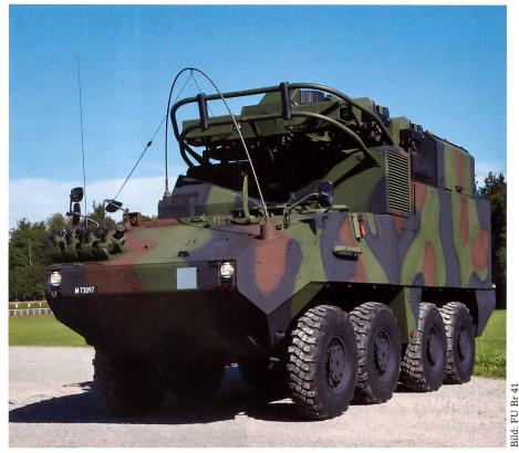
Die neue Kommunikationsplattform mit Access Point und Knotenfunktionalität, kurz KOMPAK, wurde im Kdo FUB SKS konzipiert. 2013 wurde das Pilotsystem getestet. KOMPAK bringt das IMFS, das Integrierte Militärische Fernmeldesystem, sehr schnell zum Tragen und stellt die Funkintegration mit allen möglichen, auch zivilen Funksystemen sicher. Der KOMPAK Panzer wird bei der Truppe ab Ende 2014 eingeführt.
