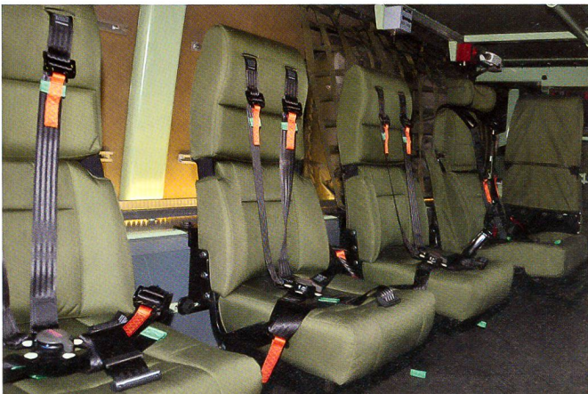
Sitzreihe links: Jeder einzelne Sitz ist seitlich verschiebbar.
