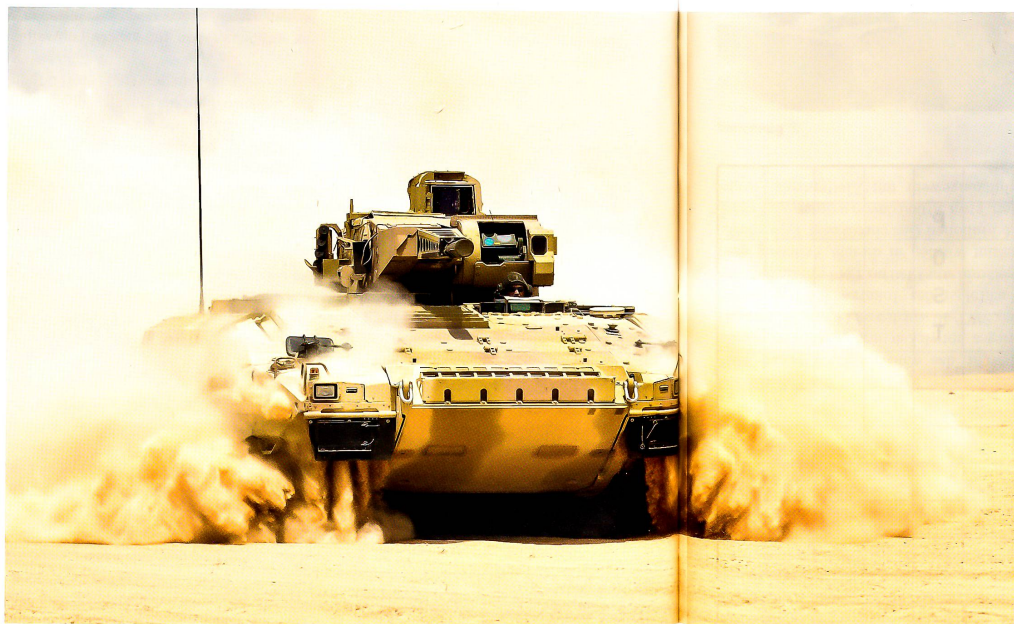
Der Kampfschützenpanzer Puma ist je nach Ausstattung zwischen 31 und 43 Tonnen schwer, hat eine 30-mm-Maschinenkanone, ein Mg 5,56 mm, einen Granatwerfer 76 bzw. 40 mm, drei Mann Besatzung und kann sechs Infanteristen mitführen.
