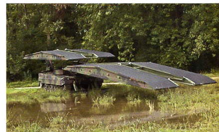
Brückenpanzer Leguan auf Leopard-2-Fahrgestell für Schweden.
