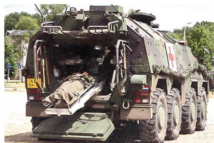
Geschützte Ambulanz auf Basis des Radpanzers Boxer.
