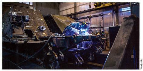
Für die Herstellung eines Geniepanzers werden über 35 km Schweissdraht eingesetzt.
