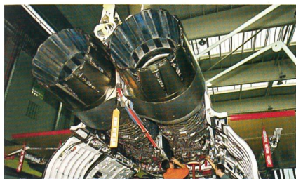
Zwei Triebwerke des Typs Eurojet EJ200 im Heck eines Eurofighters.
