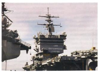
Die USS Enterprise im Marinestützpunkt von Norfolk im Dezember 1994. Der obere Teil des ursprünglichen Turmes ist entfernt worden.
