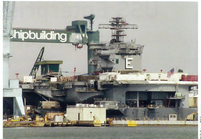
1990 bis 1994 weilte die Enterprise zu einer umfassenden Überholung und Modernisierung in der Werft von Newport News Shipbuilding Company (NNS). Die Aufnahme von 1992 zeigt das Schiff im Trockendock von NNS.
