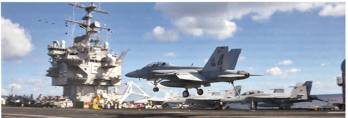
Von Januar bis Juli 2011 absolvierte die USS Enterprise die zweitletzte Dienstfahrt in den Arabischen Golf. Die Aufnahme anlässlich der Durchfahrt durchs Mittelmeer und zeigt eine FA-18F Super Hornet der Fighter Attack Squadron VFA-11 bei der Fangseil-landung.
