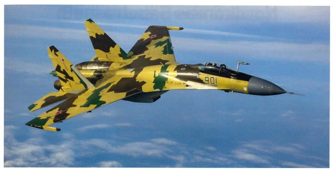
Das leistungsfähige russische Kampfflugzeug Suchoi-35 gehört zu den fortgeschrittenen Typen der vierten Generation. Der abgebildete Suchoi-35 will bald einmal in der Luft auftanken, der Refillstutzen ist ausgefahren.
