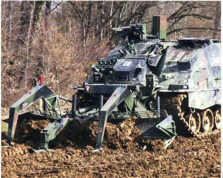
Der neue Minenräumpanzer schlägt eine Minengasse von gut 4 Metern Breite.
