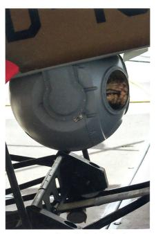
Weiter unterstützt die Luftwaffe das GWK, so mit Drohnenflügen entlang der Grenze. Hier die runde Hochleistungskamera der Ranger-Drohne ADS-95.
