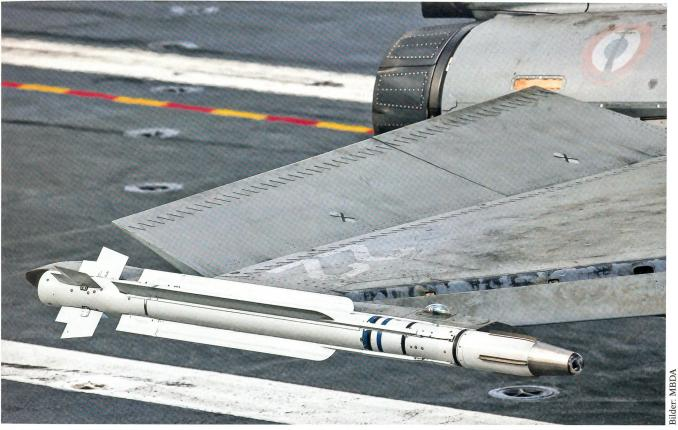
Die Luft-Luft-Lenkwaffe Mica von MBDA, montiert an einem Flügel des französischen Kampfjets Rafale.
