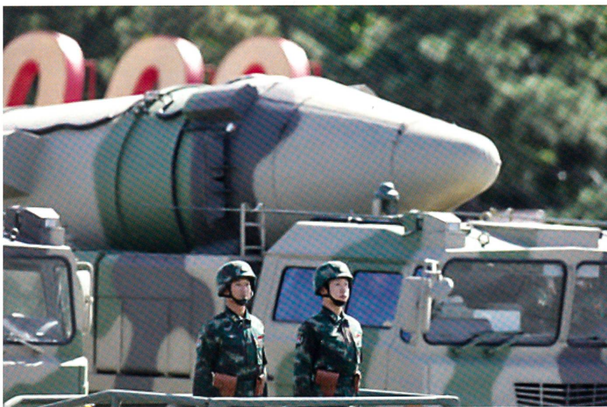
Dong Feng 21D ist eine mobile von Land aus abgefeuerten ballistische Lenkflugkörper, die über eine Reichweite von 1500 km verfügt und bewegliche Seeziele mit hoher Präzision bekämpfen können soll. Damit wird sie eine Bedrohung für Flugzeugträger.
