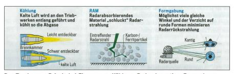
Das Tarnkappen-Prinzip bei Flugzeugen: Kühlung, Radarabsorption, Formgebung.
