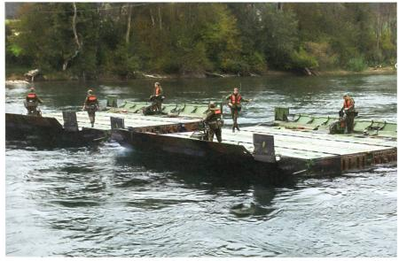
Rückbau der Fähre zu einzelnen Modulen.
