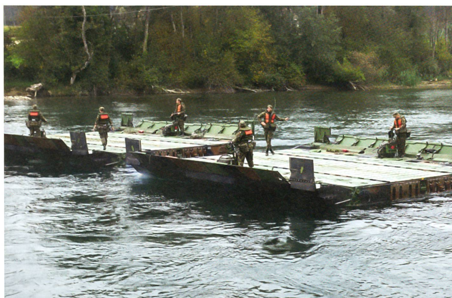
Rückbau der Fähre zu einzelnen Modulen.
