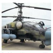
Zwei Gasturbinenmotoren VK-2500 tragen den Ka-52-Alligator auf über 5000 Meter Höhe.
