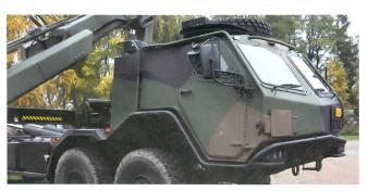
Sisu 8x8. Man beachte den starken Minenschutz unter der Kabine und die Placierung von Fahrer/Beifahrer vor der Achse.
