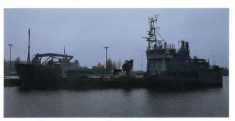
Mehrzweckschiff für Treibstoffnachschub, Unterhalt, Aufklärung, Minenräumung, Kabelverlegung und Arbeit unter Wasser.
