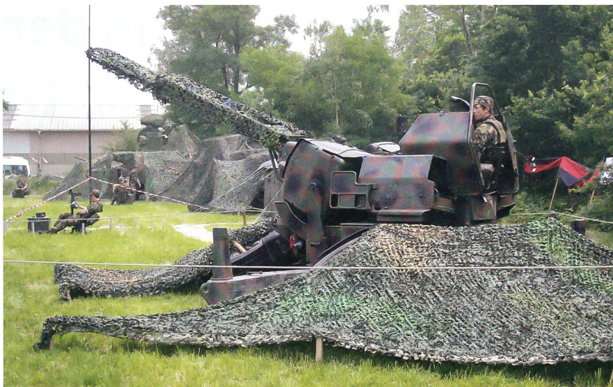
Der erste Teil von TRIO: Die 35-mm-Kanone, ein Zwillingsschütz mit zwei Läufen.
