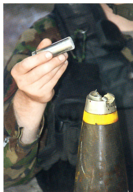
Der grosse Moment: Der Spezialist für Kampfmittelbeseitigung unterbricht bei der 10,5-cm-Granate den Zündmechanismus und macht so die Granate sicher für den Transport zur Sprengstelle.
