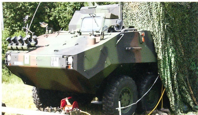
Unverkennbar ein MOWAG-Fahrzeug aus der Piranha-Familie. Die Schnauze des neuen Kommunikationspanzers zeigt die Abstammung vom Piranha-3. Gleiches gilt für den RAP-Panzer.
