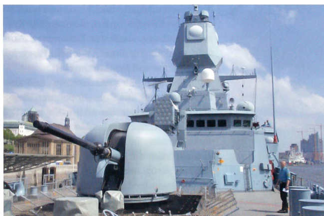
Das Vorschiff der «Sachsen» zeigt (von vorne nach hinten) das 76-mm-Oto-Melara-Geschütz, die verkleideten 32 Vertikalstartkanister für SM-2-Schiff-Luft-Lenk Waffen und ein RAM-System (mit 21 Raketen) auf.
