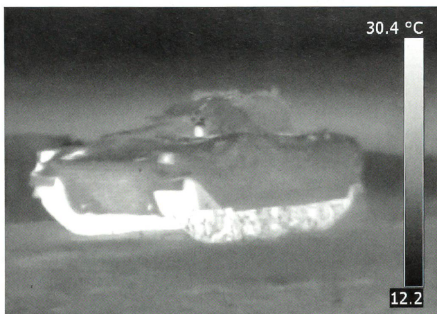
Nachtaufnahme eines KSPz mit einem SSZ-Tarn-Kit in Fahrt. Deutlich sieht man das heisse Fahrwerk, den Kopf des Fahrers und die Lampen.
