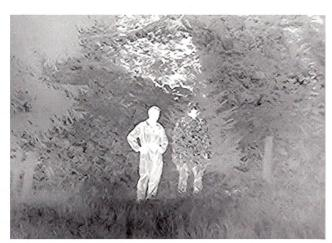
Nahaufnahme mit einer hochauflösenden Wärmebildkamera eines Standard-Kampfanzuges (links) und eines Infrarotoptimierten Kampfanzuges der Firma SSZ (rechts).
