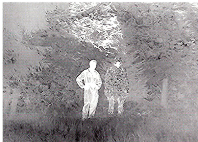
Nahaufnahme mit einer hochauflösenden Wärmebildkamera eines Standard-Kampfanzuges (links) und eines Infrarotoptimierten Kampfanzuges der Firma SSZ (rechts).
