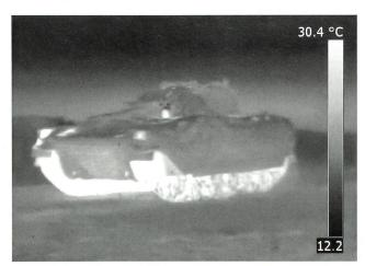
Nachtaufnahme eines KSpz mit einem SSZ-Tarn-Kit in Fahrt. Deutlich sieht man das heisse Fahrwerk, den Kopf des Fahrers und die Lampen.
