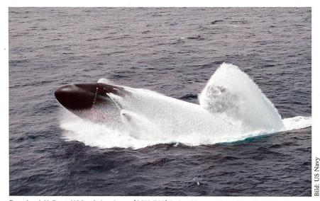
Das Jagd-U-Boot USS «Columbus» (SSN 762) beim Alarmauftauchen. Dabei gelangt das Boot bei hoher Fahrt in steilem Winkel nach oben. Danach wird es einige Momente dauern, bis es wieder ausbalanciert ist.
