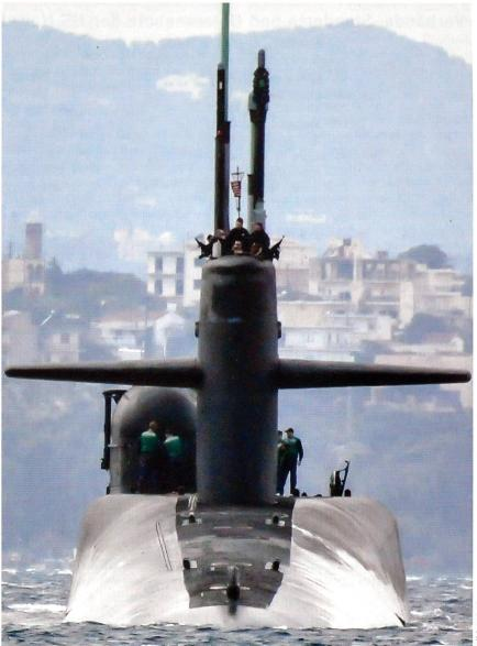
Das zum Marschflugkörperträger umgebaute ballistische Lenkwaffen-U-Boot USS «Florida» (SSGN 728), das bis zu 154 «Tomahawk» Marschflugkörper und bis zu 60 Seals mitführen kann. Für die Seals führt die «Florida» auf dem Rumpf ein ASDS mit (gut unter dem Tiefenruder links erkennbar). Dieses Spezialfahrzeug kann Special Operation Forces (SOF oder Seals) für Sonderaufgaben in Küstennähe bringen.
