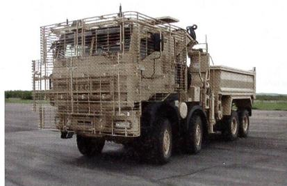
**Britischer Iveco Trakker 8x8 mit Käfigpanzerung.**
