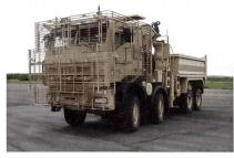
Britischer Iveco Trakker 8 x 8 mit Käfigpanzerung.
