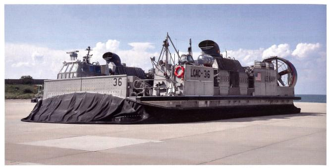
Die US Navy verfügt über zahlreiche Luftkissenfahrzeuge des Typs LCAC, welche Nutzlasten von bis zu 72 Tonnen transportieren können. Der Autor konnte diese Einheit «36» vor der JEB Little Creek auf dem Meer für einige Zeit fahren.
