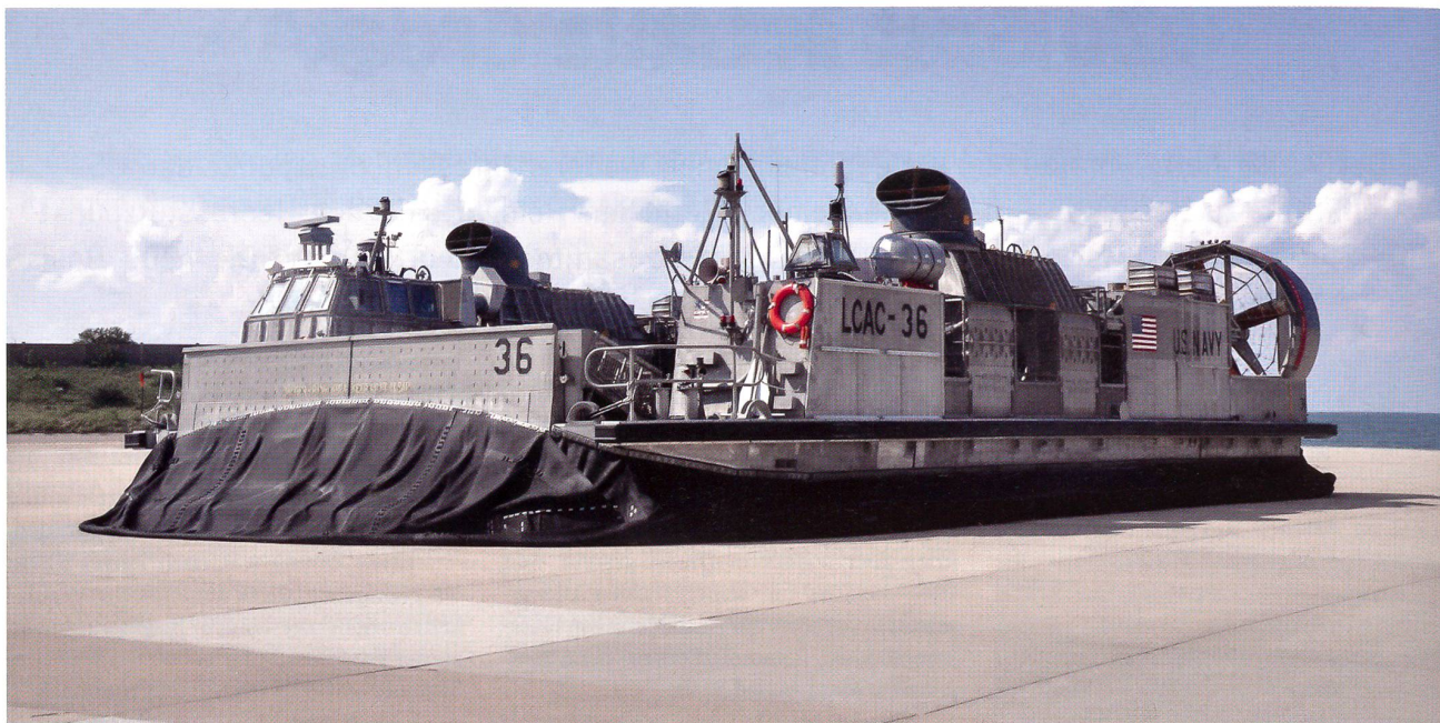
Die US Navy verfügt über zahlreiche Luftkissenfahrzeuge des Typs LCAC, welche Nutzlasten von bis zu 72 Tonnen transportieren können. Der Autor konnte diese Einheit «36» vor der JEB Little Creek auf dem Meer für einige Zeit fahren.
