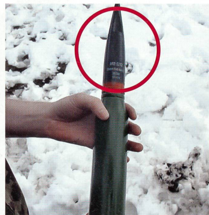
Für S-chanf wurde eine spezielle Munition entwickelt. Eingefräste Rillen an der Spitze brechen die Flugbahn früher ab.
