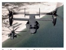
Zwei Turbopropeller-Triebwerke des Typs AE 1107C an einem V-22 Osprey.
