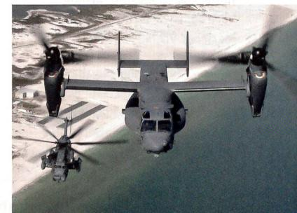
Zwei Turbopropeller-Triebwerke des Typs AE 1107C an einem V-22 Osprey.
