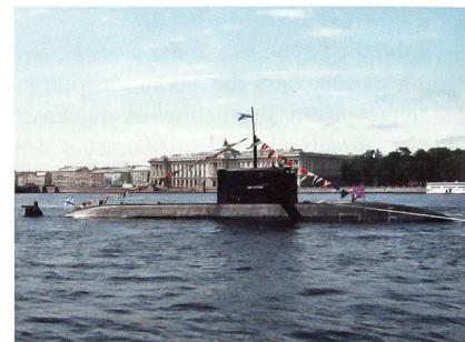
**Konventionelles U-Boot Amur-1650 mit aussenluftunabhängigem Antrieb.**
