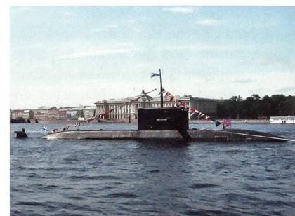
**Konventionelles U-Boot Amur-1650 mit aussenluftunabhängigem Antrieb.**
