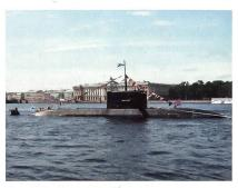
Konventionelles U-Boot Amur-1650 mit aussenluftunabhängigem Antrieb.
