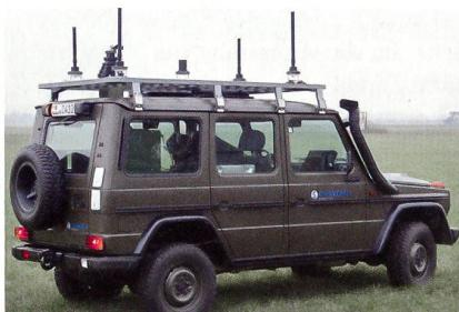
**Cassidian «Vehicle Protection Jammer» auf einem Versuchsfahrzeug.**
