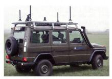
Cassidian «Vehicle Protection Jammer» auf einem Versuchsfahrzeug.
