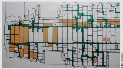
Ein typischer Decksplan, wie er auf allen Kriegsschiffen verwendet wird. Er zeigt hier im Detail sämtliche Räume im Heckteil des 03 Decks an Bord des Flugzeugträgers USS George H.W. Bush (CVN 77). Diese Übersichten dienen u.a. im Damage Control Center zur Erstellung eines Schadensbildes und zum Einsatz der Einsatzkräfte.
