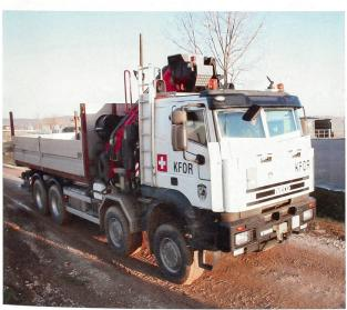
Splittergeschützter Schweizer Iveco mit einem 20-Tonnen-Kran.
