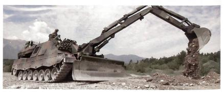
Schweden: Pionierpanzer Kodiak bei Erdarbeiten mit der Knickarm-Baggeranlage.
